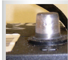
MODIFICADO Cuando se reconstruye un poste para ocultar algún daño.
