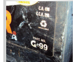
RASPADA Por no estar bien sujeta a su base.
