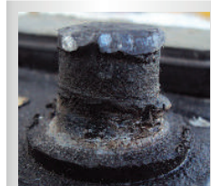
GOLPEADO Golpes directos o al golpear el poste cuando no se abre correctamente la terminal.
