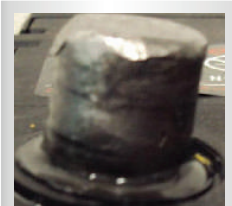
DOBLADO Ocurre al golpear el poste o terminal con algún objeto o por levantar con pinzas.
