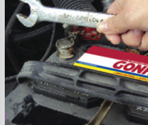
CORTO PROVOCADO Por unir los postes con algún objeto metálico para comprobar carga o que los postes hagan contacto con el cofre.
